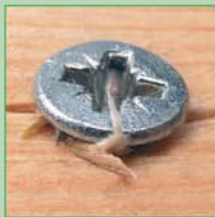
Bei herkömmlicher Spanplattenschraube Gefahr des Spleißens bei Versenken des Kopfes.
