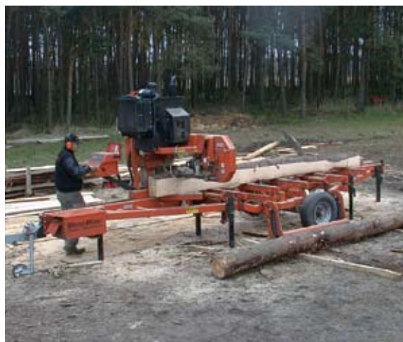
Mobile Bandsägen werden auf einem Anhänger bis zum gefälltten Baum gefahren.
