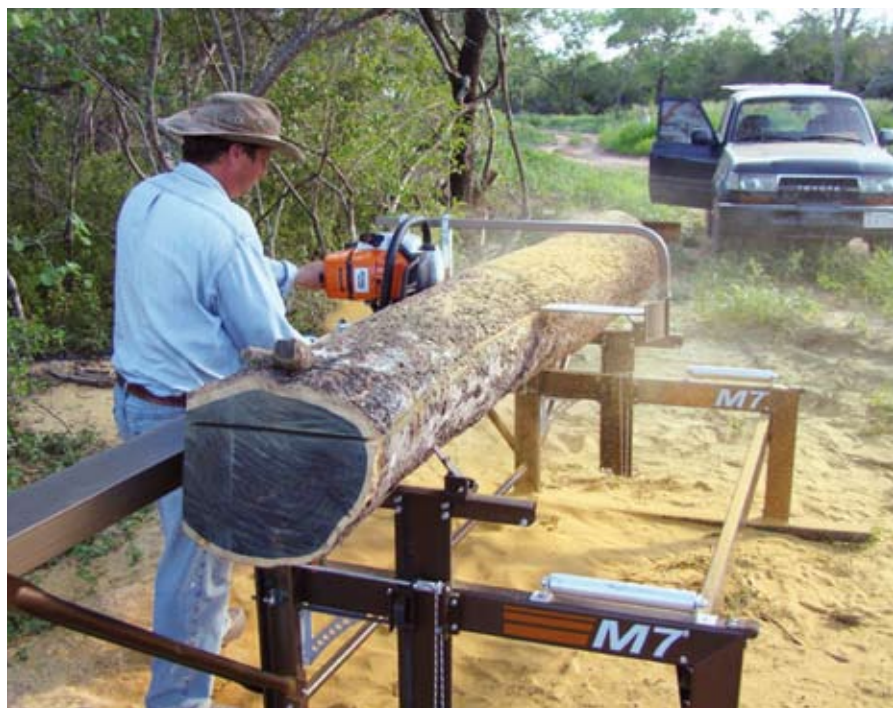
Holzeinschnitt mit der Kettensäge, die auf einer Schiene läuft
