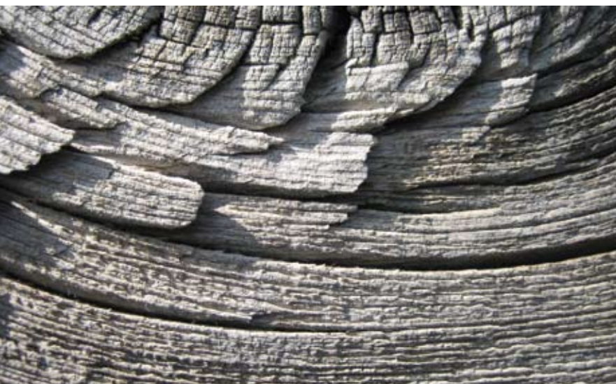
Detailaufnahme in den Alpen: Die UV-Strahlung hat die oberen Zellschichten zerstört und es ist zu einer Vergrauung gekommen. Das Holz ist aufgerissen.
