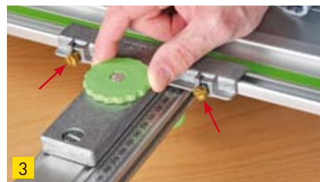
3 Ist die richtige Position auf der Schiene erreicht wird der Anschlag über ein Drehrad fest an die Schiene gezogen. Mit den beiden Einstellschrauben (Pfeile) kann der Anschlag genau im rechten Winkel zur Schiene justiert werden.
