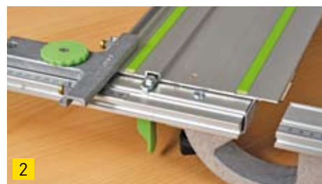
2 Die beiden Anschlagleisten werden einfach in die obere und untere Nut der Führungsschiene jeweils vom Ende her eingeschoben.
