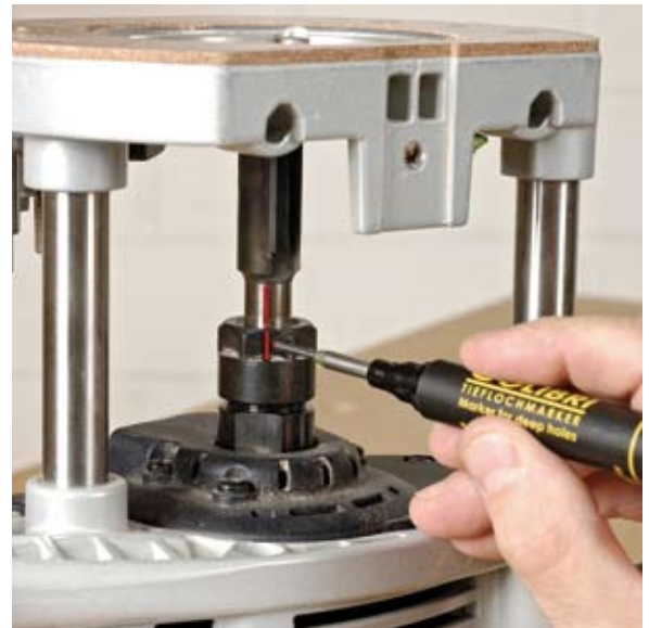
Ein langer, senkrechter Strich auf dem Fräserschaft und der Überwurfmutter gibt Gewissheit darüber, ob die Spannzange noch über ausreichend Haltekraft verfügt.
