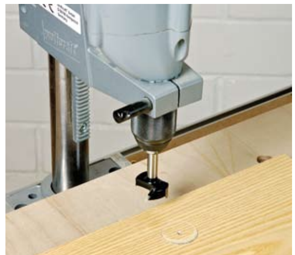
Ist der Kranz, den der Bohrer hinterlässt, nicht absolut gleichmäßig, sondern im vorderen Bereich etwas tiefer, dann muss die Holzauflage im Bereich der Bohrsäule angehoben werden.
