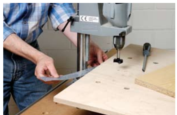
Dazu wird einfach ein Streifen dünnes Furnier oder Papier im hinteren Bereich unter die Holzauflage geschoben und nochmals getestet. Sieht der Kranz gleichmäßig aus (Bild links: Kreis 1) bohrt der Bohrständer absolut senkrechte Löcher.
