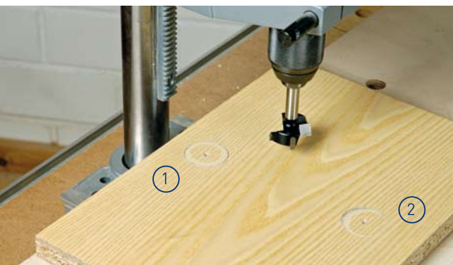
Dazu wird einfach ein Streifen dünnes Furnier oder Papier im hinteren Bereich unter die Holzauflage geschoben und nochmals getestet. Sieht der Kranz gleichmäßig aus (Bild links: Kreis 1) bohrt der Bohrständer absolut senkrechte Löcher.
