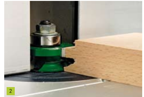
... bis der obere Nutfräser genau auf der Höhe des geraden Zapfens liegt. Der soll später ja genau in diese gefräste Nut eingreifen.
