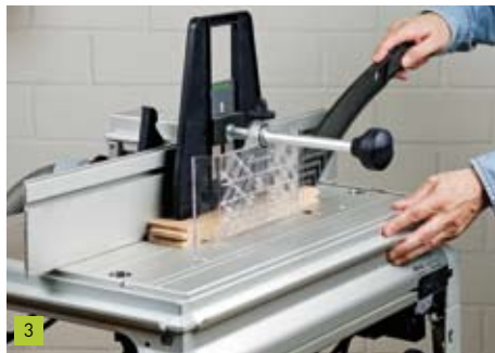
Dann werden alle Rahmenhölzer (aufrechte und Querriese) an einer Längskante profiliert. Achten Sie darauf, dass die Rahmen beim Fräsen mit der Außenseite auf der Tischfläche aufliegen müssen!
