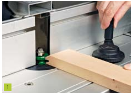
Legen Sie eine gefräste Stirnkante gegen den Fräser und senken Sie ihn nach unten in die Tischöffnung soweit ab ...
