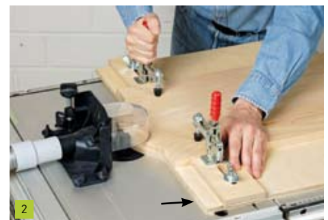
Schalten Sie die Maschine ein und führen Sie die vordere Schablonekante (Pfeil), an der noch keine Füllung übersteht, langsam gegen das Kugellager, dort gibt es keine Rückschlaggefahr.
