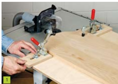
Legen Sie die Füllung genau mittig auf die Schablone. Anschließend schieben Sie die Anschlaghölzer an die Füllung und fixieren das Ganze mit den Schnellspannern.
