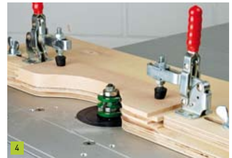
Da es sicherer (und präziser!) ist, die Längskante zusammen mit der darunter liegenden Schablone zu fräsen, müssen Sie die Fräserhöhe für diesen Arbeitsschritt wieder neu einstellen (höher!).
