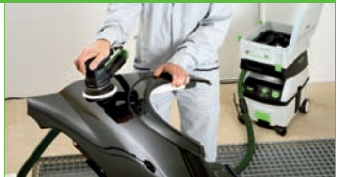
... und das in einer Oberflächenqualität, die seinen Einsatz auch zum Feinstschliff von Karosseriebauteilen zur Poliervorbereitung erlaubt.
