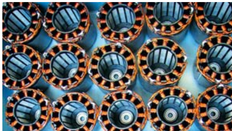
Klares Bekenntnis zum Standort Deutschland: Die neuen, patentierten EC-Tec Motoren stellt Festool selber auf hochmodernen Fertigungsanlagen im schwäbischen Neidlingen her (im Bild zu sehen sind Statoren)
