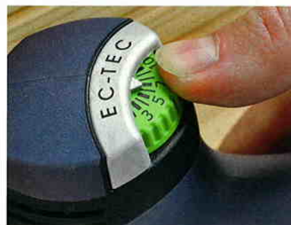
KRAFT-VORWAHL: Das Einstellrad liegt hinten am Motorgehäuse, so ist eine einhändige Bedienung möglich
