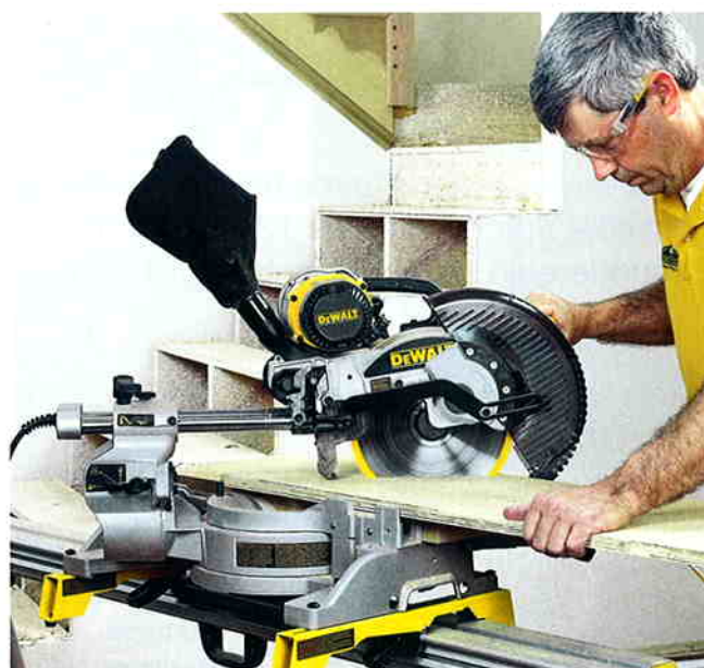
Einfach und exakt: Schlagschatten des Sägeblatts zeigt Schnittposition
